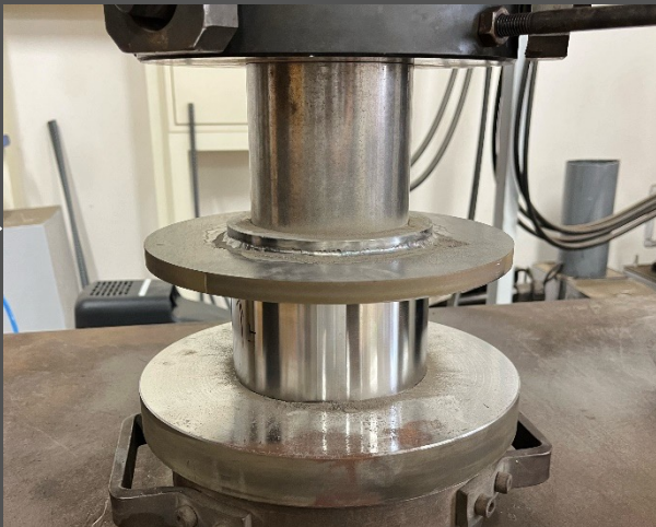
Compression( 600\text{kN}=75\text{N/mm}^2 )
