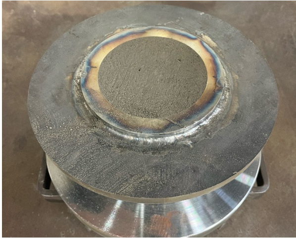
Compression( 600\text{kN}=75\text{N/mm}^2 )
